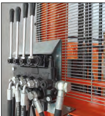
Control hidráulico de la ES70580
