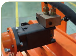
Motor hidráulico regulable del rodillo alimentador.
