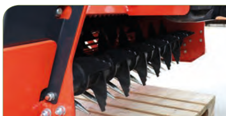
Puas y rodillo alimentador independiente y regulable.
