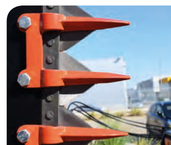
21 secciones dentadas y dobles dedos.
