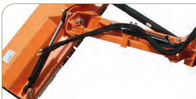
2 hidráulicos para giro lateral y eje.
