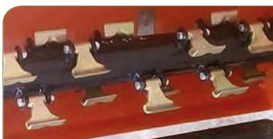
Martillos y eje de 170 mm.
