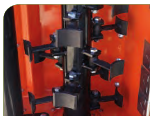
24 martillos en un eje rotor de 78 mm.
