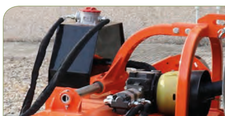
Sistema hidráulico: depósito + doble bomba
