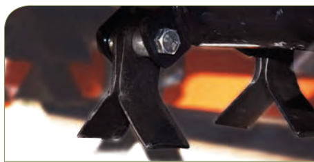
Cuchillas dobles reforzadas.
