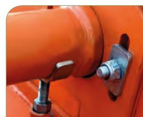
Ajuste de correas y cadenas.
