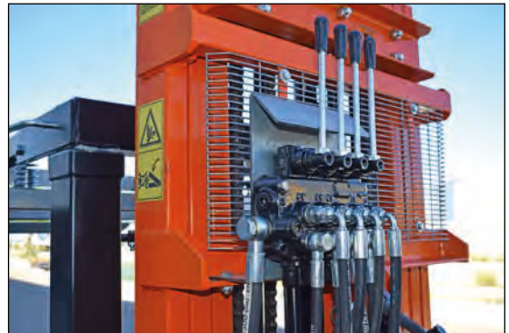
Control hidráulico de la ES70697
