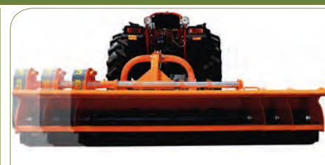
Desplazamiento horizontal de hasta 500 mm. Apertura ajustable
