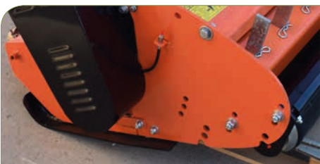
Rastrojeros, patines y rodillo regulables en altura.
